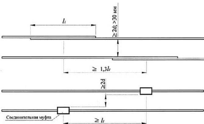
$d$  - диаметр арматурных стержней;  $l$  - длина перепуска (нахлестки) арматурных стержней
