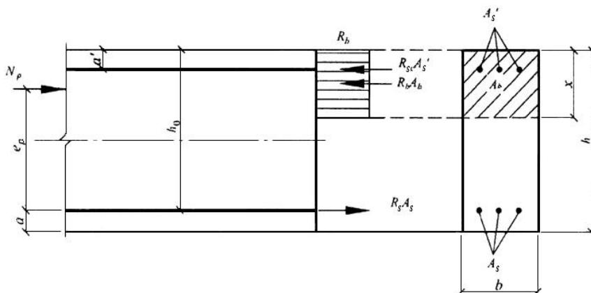
Рисунок 9.1 - Схема усилий и эпюра напряжений в сечении, нормальном к продольной оси изгибающегося предварительно напряженного элемента при его расчете по прочности в стадии обжатия
