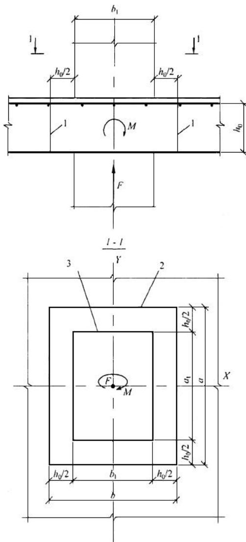
1 - расчетное поперечное сечение; 2 - контур расчетного поперечного сечения;
