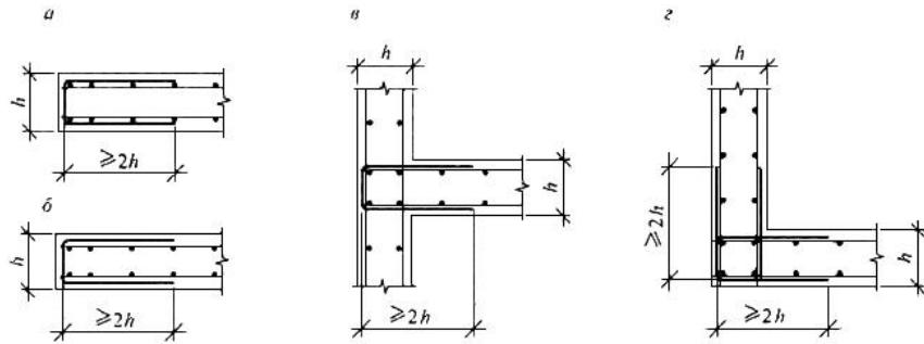
а - торцевой участок плиты, б - торцевой участок стены, в - Т-образный стык,
