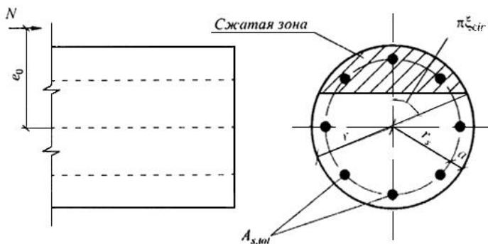
**Рисунок Д.2 - Схема, принимаемая при расчете круглого сечения внерадиально сжатого элемента**
