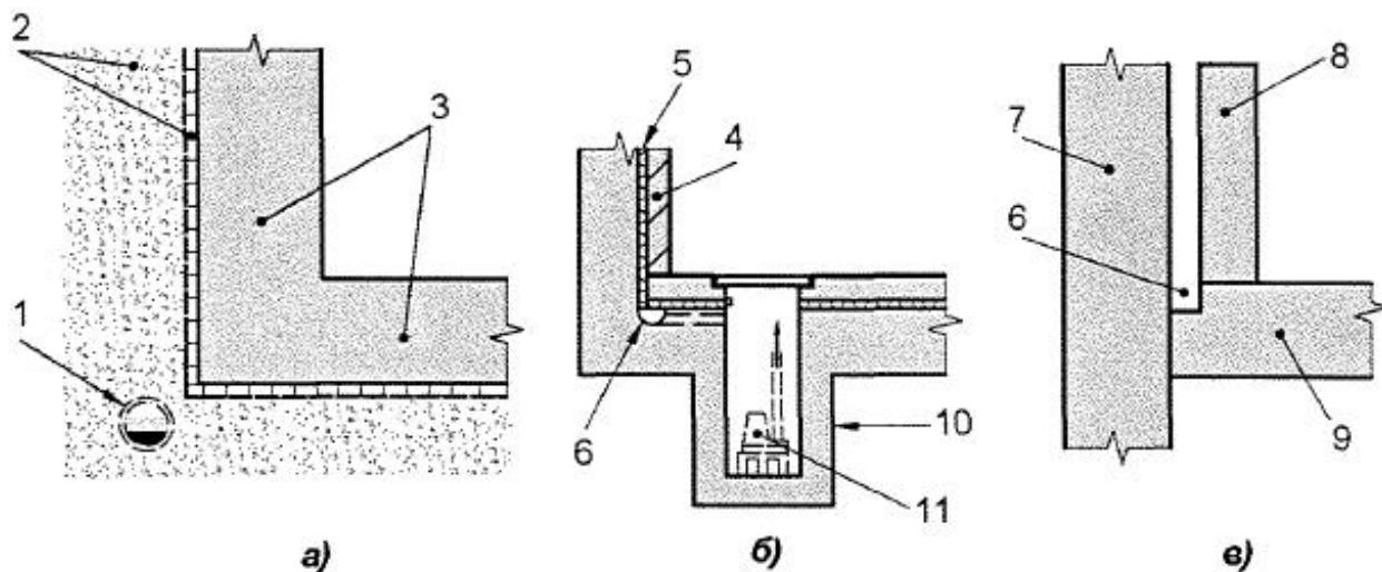
а) наружный дренаж; б) внутренний дренаж с мембраной; в) внутренний дренаж без мембранны 1 - дренажная труба; 2 - дренажный слой грунта или мембрана; 3 - наружные стены и фундамент; 4 - прижимные конструкции; 5 - дренажная мембрана; 6 - дренажный канал; 7 - стена в грунте; 8 - фальш-стена; 9 - фундаментная плита; 10 - приямок; 11 - насос
