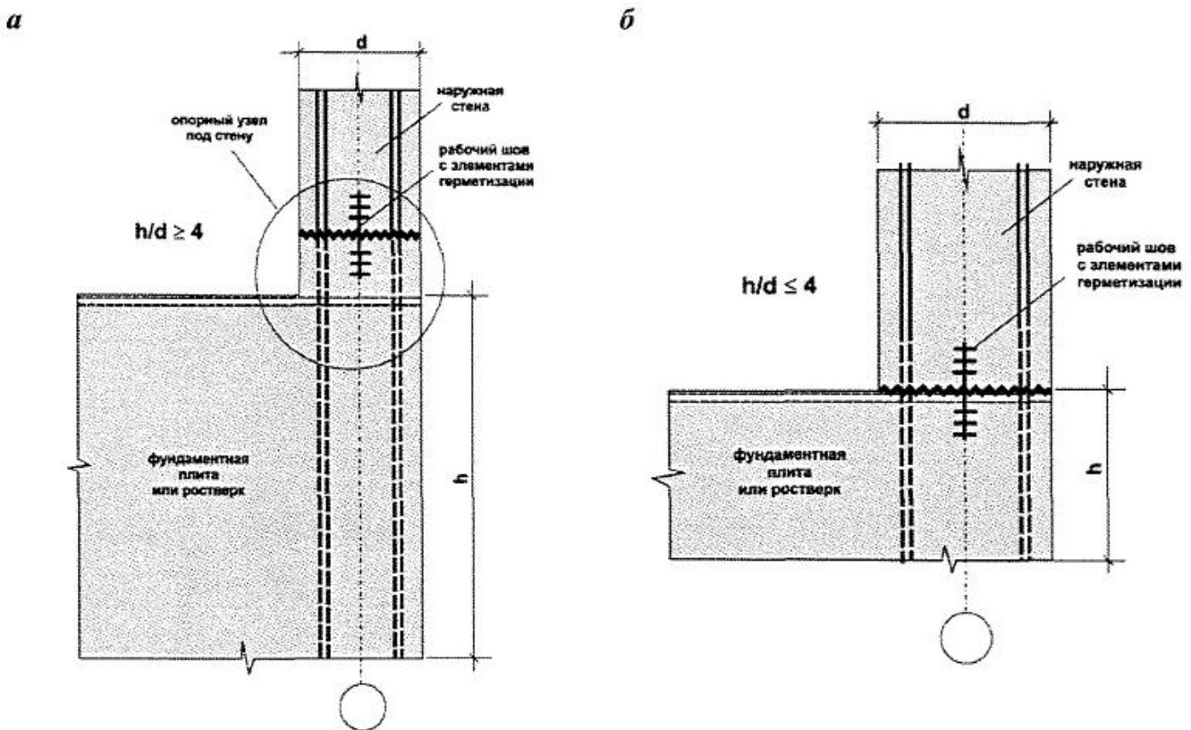
$h$  - толщина фундаментной плиты;  $d$  - толщина наружной стены
