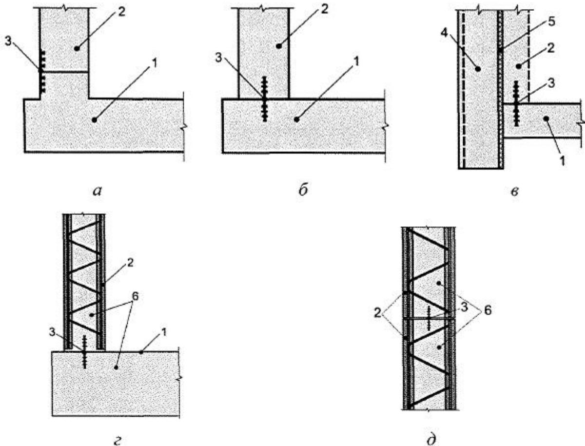
1 - водонепроницаемая фундаментная плита; 2 - водонепроницаемая монолитная стена (а, б, в)/сборный стеновой блок (г, д); 3 - элементы герметизации; 4 - стена в грунте; 5 - скользящий слой; 6 - монолитный бетон
