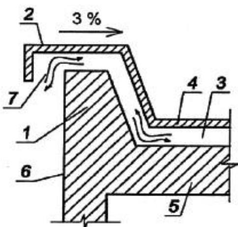
1 - парапет; 2 - козыrek; 3 - вентилируемая воздушная прослойка или канал; 4 - верхняя часть крыши; 5 - нижняя часть крыши; 6 - стена; 7 - направления движения воздуха
