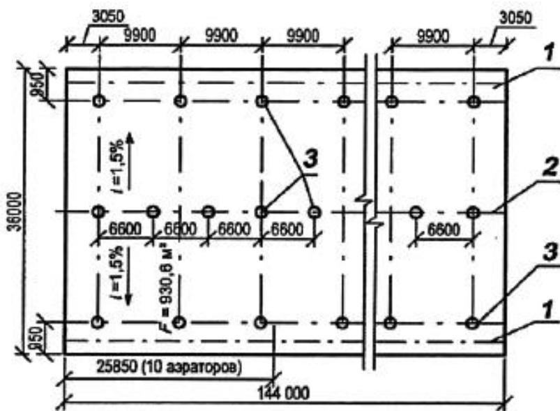
**Рисунок А.4 - План расположения аэраторов диаметром 100 мм**
