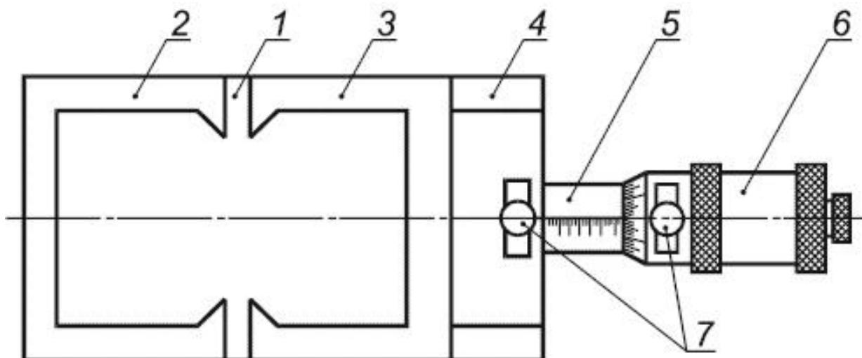
1 - основание; 2 - упорная планка; 3 - подвижный П-образный захват; 4 - неподвижный зажим; 5 - внутренний цилиндр растягивающего механизма; 6 - наружный цилиндр растягивающего механизма; 7 - зажимные винты
