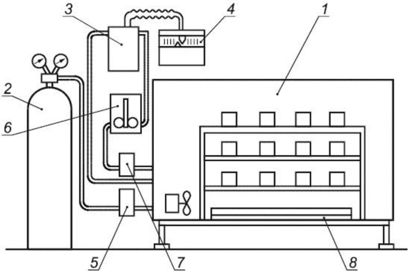
1 - камера; 2 - баллон с  $\text{CO}_2$ ; 3 - автоматический газоанализатор; 4 - показывающий командный прибор; 5 - электромагнитный клапан; 6 - блок регулирования; 7 - побудитель расхода газа; 8 - ванна с раствором хлорида натрия
