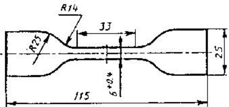
Рисунок 1 - Образец-лопатка типа 1
