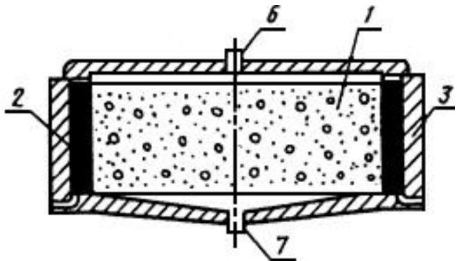
Способ уплотнения боковой поверхности образца резиновой полой камерой с избыточным давлением в ней
