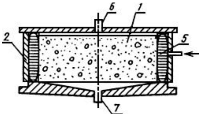
1 - образец бетона; 2 - испытательная обойма; 3 - мастика; 4 - набор резиновых и металлических колец; 5 - резиновая полая камера; 6 - съемная крышка для подачи воды; 7 - съемная крышка с патрубком для сбора фильтрата
